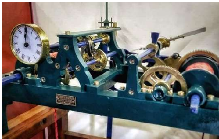
Figura 6 Máquina del reloj luego de su restauración.
